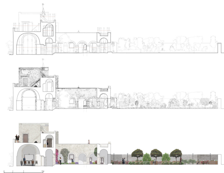
Fig. 10. Sezione significativa del complesso passante per chiostro e orto; a partire dall'alto: quadro del degrado delle superfici, quadro igroscopico, quadro del degrado antropico (elaborazione di Corallo N. A., 2023).
